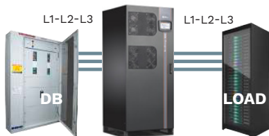
Installation à 3 câbles (L1-L2-L3)
